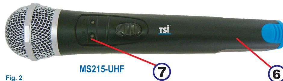
Solte a tampa na parte traseira do microfone, coloque as pilhas de acordo com a polaridade. Ligue o microfone o led vermelho pisca brevemente e o led de cor verde ficara **aceso levemente** indicando estado normal de operação, se nenhum brilho ocorrer, verifique se as pilhas foram inseridas corretamente e caso o led vermelho permaneça aceso é um aviso que as pilhas estão com as cargas quase esgotadas.
